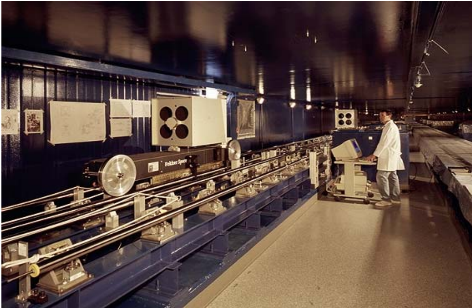
Abbildung 1.4.11: Optische Verzögerungseinrichtung (delay lines) des VLT Interferometers. Die Wagen tragen Retroreflektoren und können sich über eine Strecke von 60 m mit hoher Präzision bewegen.
